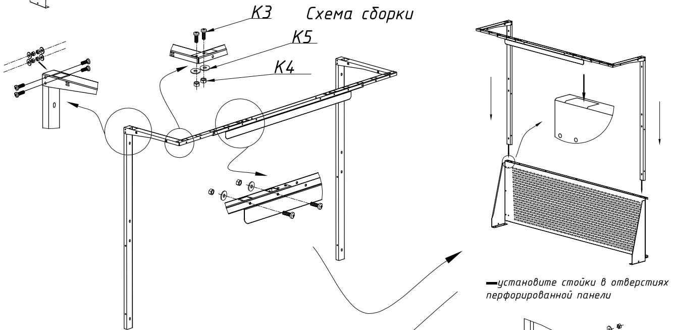
—в соответствии с шириной столешницы верстака соберите балку под светильник с помощью винтов и гаек M5
