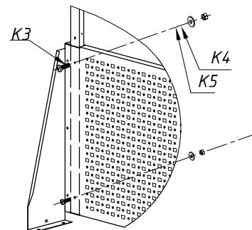
—так же соедините стойки с перфорированными панелями с помощью винтов, шайб и гаек M5
