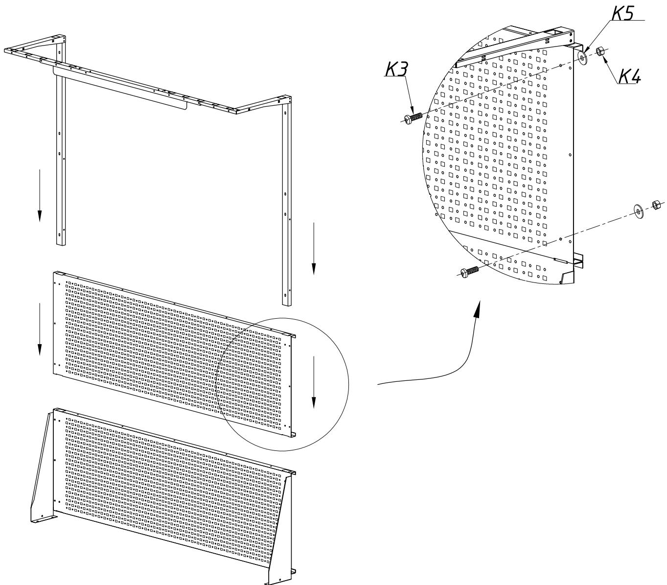
1. Для установки второго экрана на уже собранное освещение (с одним экраном) необходимо отсоединить комплект освещения от экрана на верстаке.
