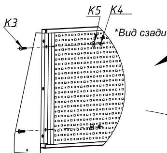
—соедините кронштейны со стойками с помощью винтов, шайб и гаек M5
